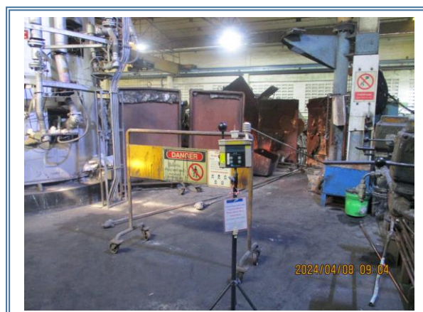
รูปที่ 4-48 แสดงการตรวจวัดระดับความร้อนในการทำงาน รางส่งน้ำทองแดง 1 (คุณณัฐนันท์ คำสุข) ตรวจวัดในวันที่ 8 เมษายน 2567
