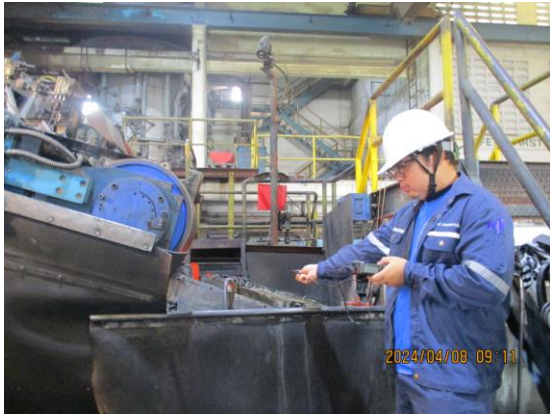
รูปที่ 4-40 แสดงการตรวจวัดความเข้มข้นของแสงสว่าง บริเวณหน้าเครื่องหล่อ (คุณฉลอง ปิ่นประดับ) ตรวจวัดในวันที่ 8 เมษายน 2567
