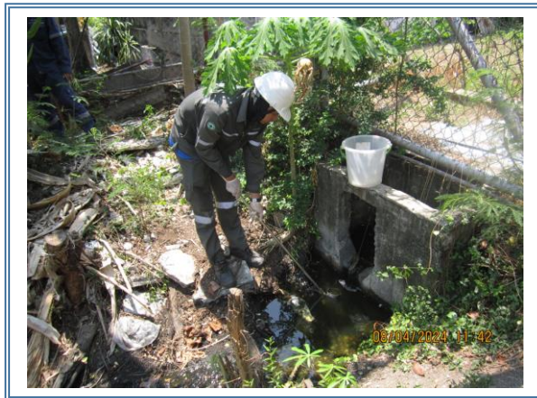
รูปที่ 4-30 แสดงการเก็บตัวอย่างน้ำทั้ง บริเวณรางระบายน้ำฝนฝั่งตะวันออกก่อน ระบายลงสู่คลองสำโรง เก็บตัวอย่างในวันที่ 8 เมษายน 2567
