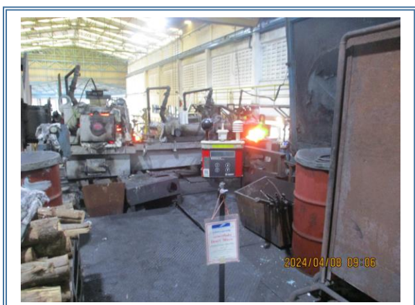
รูปที่ 4-49 แสดงการตรวจวัดระดับความร้อนในการทำงาน รางส่งน้ำทองแดง 2 (คุณนาฏ เทียนกร) ตรวจวัดในวันที่ 8 เมษายน 2567
