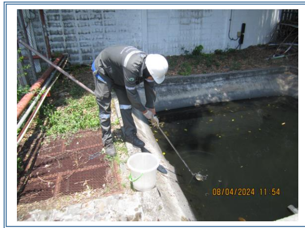
รูปที่ 4-29 แสดงการเก็บตัวอย่างน้ำทั้ง บริเวณน้ำก่อนเข้าระบบบำบัดน้ำเสีย เก็บตัวอย่างในวันที่ 8 เมษายน 2567
