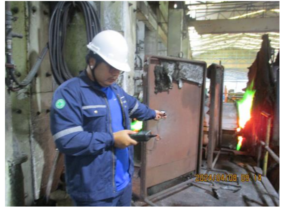
รูปที่ 4-41 แสดงการตรวจวัดความเข้มข้นของแสงสว่าง บริเวณรางส่งน้ำทองแดง 1 (คุณณัฐนันท์ คำสุข) ตรวจวัดในวันที่ 8 เมษายน 2567
