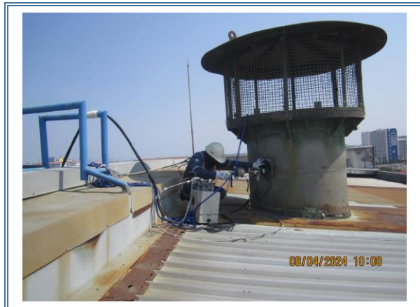
รูปที่ 4-34 แสดงการตรวจวัดปริมาณสารเจือปนในอากาศ ที่ระบายออกจากปล่องระบายเตาหลอม เก็บตัวอย่างในวันที่ 8 เมษายน 2567
