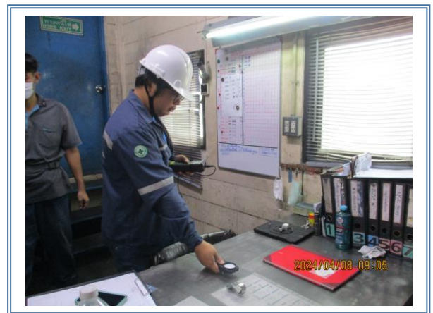
รูปที่ 4-45 แสดงการตรวจวัดความเข้มข้นของแสงสว่าง ห้องควบคุม Furnace โต๊ะทำงานคุณคุณณัฐนันท์ คำสุข ตรวจวัดในวันที่ 8 เมษายน 2567
