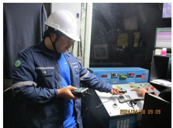
รูปที่ 4-43 แสดงการตรวจวัดความเข้มข้นของแสงสว่าง บริเวณห้องควบคุม Caster Cabin (คุณนาย เทียนกร) ตรวจวัดในวันที่ 8 เมษายน 2567
