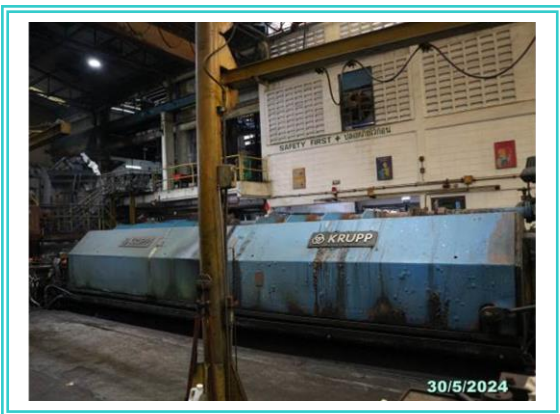
รูปที่ 3-27 เครื่องจักรมีฝาครอบลดความดัง
